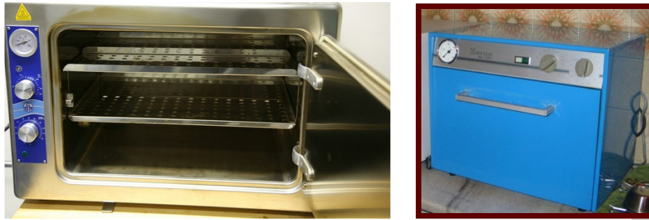
شکل ۹-۲. فور یا آون یا حرارت خشک یا OVEN (نوع رومیزی یا قابل حمل). اندازه دستگاه بر مبنای لیتر، حجم مفید داخلی آن است.
