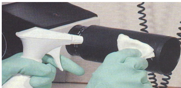
شکل ۷-۱۴. ضدعفونی کردن cone دستگاه رادیوگرافی به روش spray
