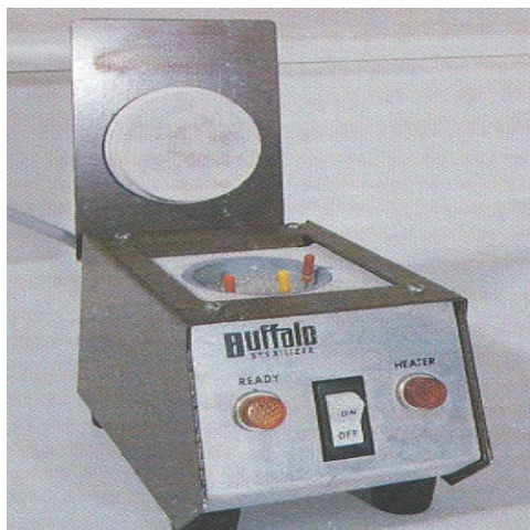
شکل ۵-۱۴. Glass bead / salt sterilizers ذرات باید کمتر از ۱ میلی‌متر باشد تا حرارت خشک به خوبی در محفظه پخش شود.
