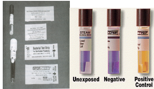
شکل ۹-۹: نشانگرهای بیولوژیک مطمئن ترین روش ارزیابی کیفی استریلیزاتورها می باشد.
