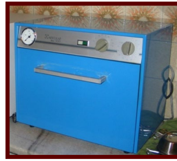
شکل ۲-۹. فور یا آون یا حرارت خشک یا oven (نوع رومیزی یا قابل حمل). اندازه دستگاه بر مبنای لیتر، حجم مفید داخلی آن است.
