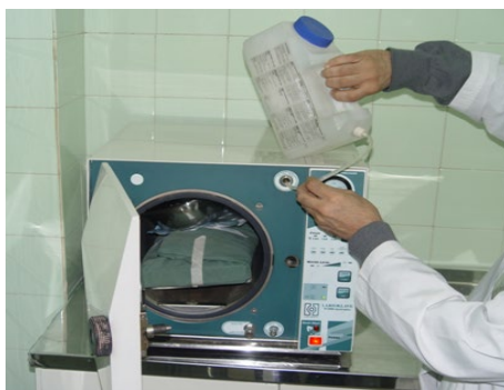
شکل ۲-۹. فور یا آون یا حرارت خشک یا oven (نوع رومیزی یا قابل حمل). اندازه دستگاه بر مبنای لیتر، حجم مفید داخلی آن است.
