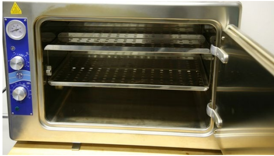
شکل ۲-۹. فور یا آون یا حرارت خشک یا oven (نوع رومیزی یا قابل حمل). اندازه دستگاه بر مبنای لیتر، حجم مفید داخلی آن است.
